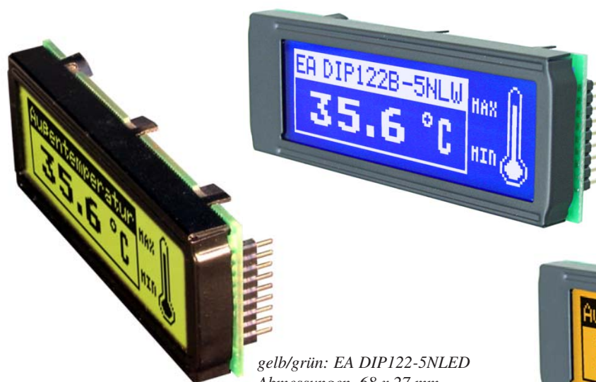
blau-weiss: EA DIP122B-5NLW Abmessungen 75 x 27 mm
