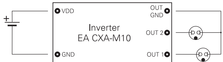
Außenbeschaltung des Inverters
