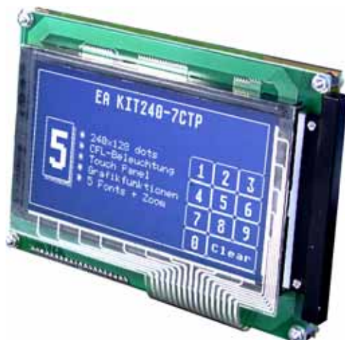
EA KIT240-7CTP Abmessungen 144x104mm
